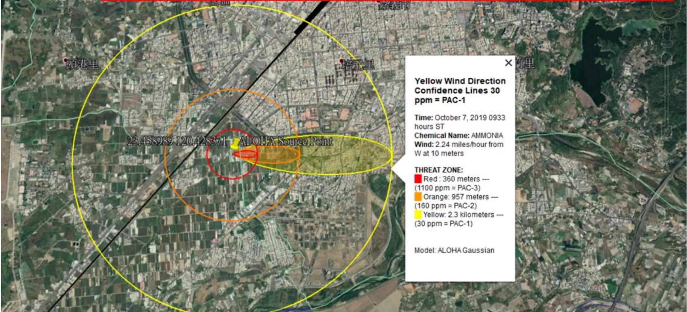
風速1.5m/s、風向NE、氣象測站高度3m、地形都市、氣溫29.7°C、濕度79%、穩定度F、污染源類型直接 (Direct)、模式連續(continuous)、儲槽容積或平均儲存量 L、液體或氣體(溫度及壓力)、經緯度 或直接附上ALOHA Text Summary
